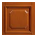
kazeta model B s tepelněizolační PUR výplní smrk, meranti, borovice tl. 24 mm, U = 1,1 \text{ W/m}^2\text{K}
