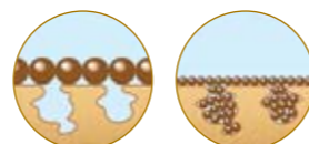
Nanočástice pronikají do hloubky dřeva a zajišťují optimální ochranu a vynikající přilnavost.
