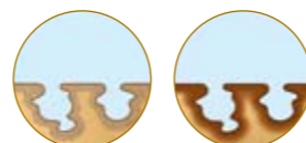
Aktivní složky impregnace zůstávají i po vypaření tekutiny.
